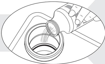
⚠ Asegúrese de que la cámara de polvo esté perfectamente seca. La presencia de humedad puede crear concreciones en el polvo.
