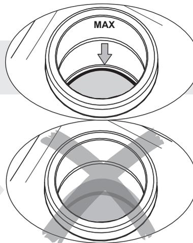
⚠ Assicurarsi che il vano per la polvere sia perfettamente asciutto. La presenza di umidità può creare delle concrezioni nella polvere.
